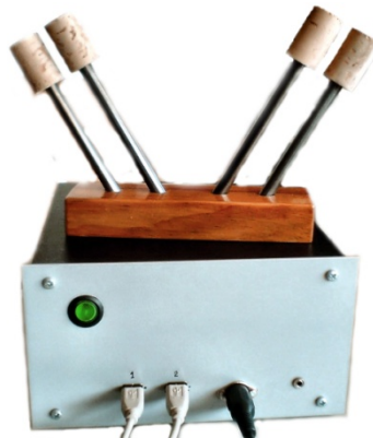
Figura 3: Protótipo do TheraMax – Theremin ultrasónico com interface MIDI.
